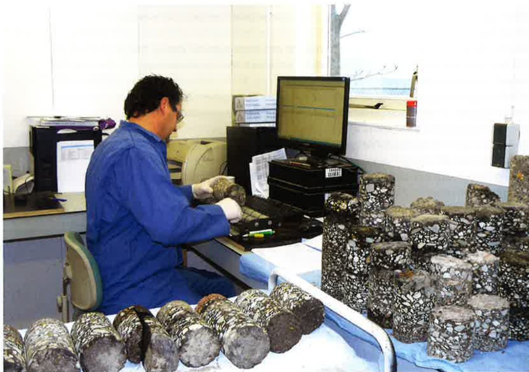
Foto 7. Bepalen van de asfaltnengsels en de laagdikte
