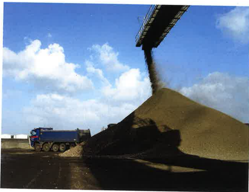
Foto 12. Na het thermisch verwerken van teerhoudend asfalt blijven herbruikbare toeslagmaterialen over
